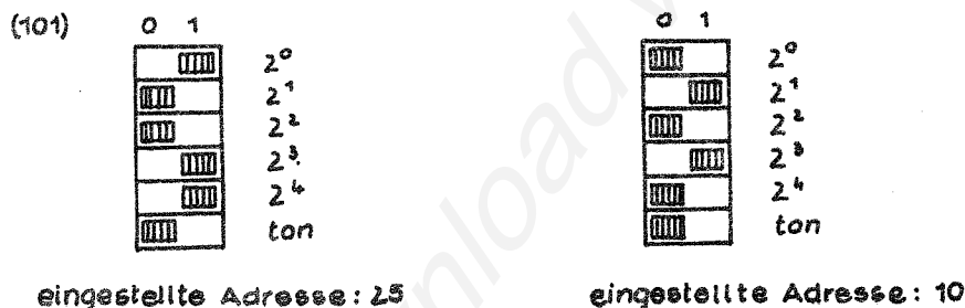
Bild 25: Adresseneinstellung beim G-2005.500/510
